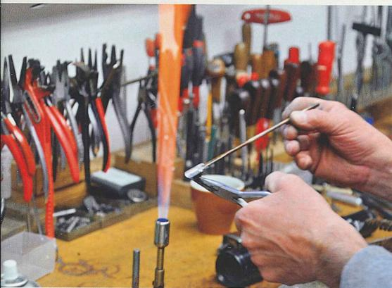
**F**auchend erlischt der Bunsenbrenner. Hans Peitler kneift ein Auge zusammen und schaut über den Lauf zur Mündung. Mit einem zufriedenen Brummen zieht er die Schraubzwinde um den Gewehrlauf fester: Passt. Der Riemenbügel, den er aufgelötet hat, sitzt mittig. Ein alltäglicher Reparaturauftrag für den angestellten Büchsenmachermeister in der Werkstatt von Oliver Kratochwil.
